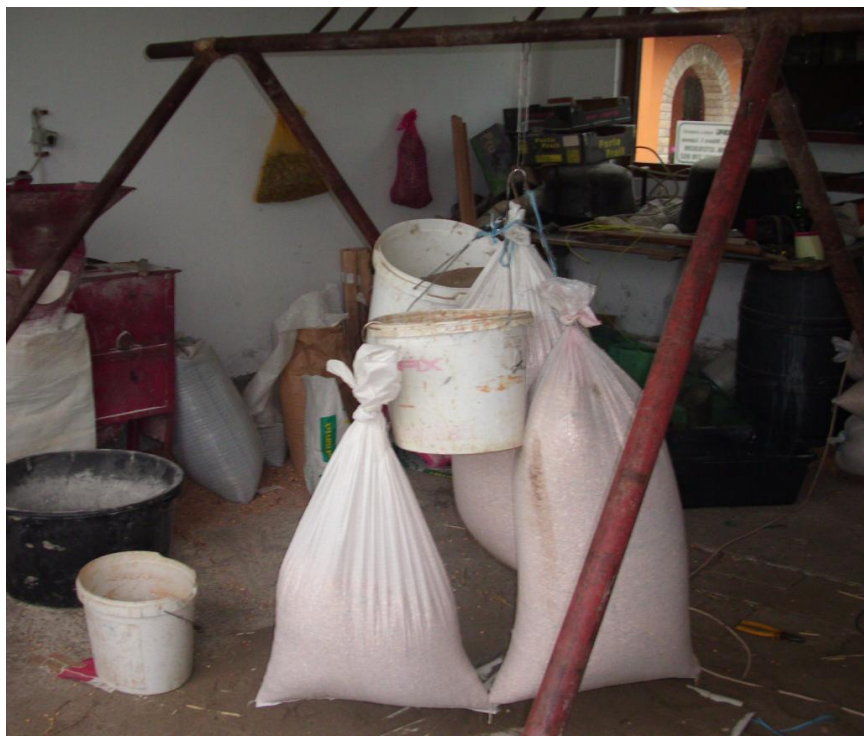
Slika 13. Prikaz ispitivanja smične čvrstoće
