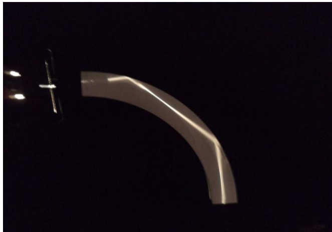
Slika 6. Fotografija totalne refleksije, snop svjetlosti se reflektira kroz polimerni medij
