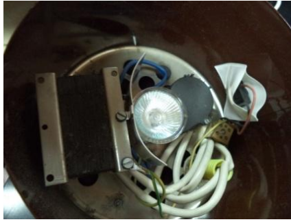
Slika 13. Fotografija unutrašnjosti lampe, halogena žarulja i motor
